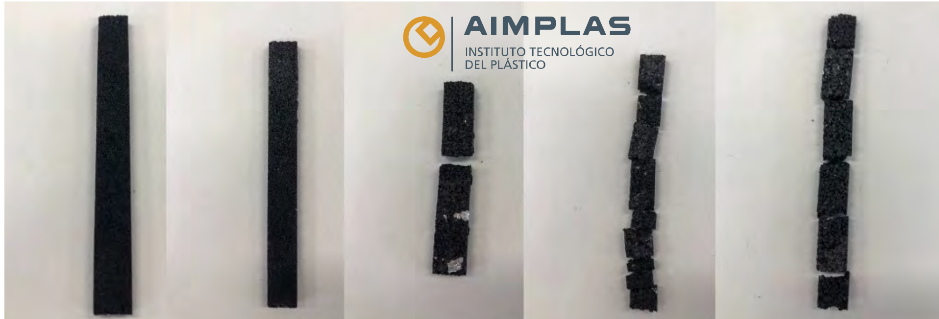
Probetas preparados con diferentes distribuciones de tamaño de partícula por AIMPLAS
